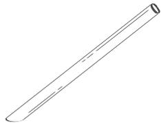
1 tuyau d'environ 1po de diamètre et ~60cm de long coupé en biseau à une extrémité
